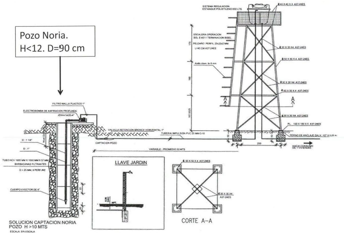
**TIPO 2: Vertiente con impulsión a estanque sobre torre metálica**
